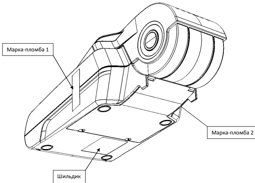
Два элемента марки-пломбы наклеиваются с двух сторон на кожух, закрывающий блок управления и устройства печати кассовых чеков так, чтобы было невозможно получить доступ к внутренней части ККТ без разрушения марки-пломбы. Шильдик наклеивается на дно корпуса ККТ.
