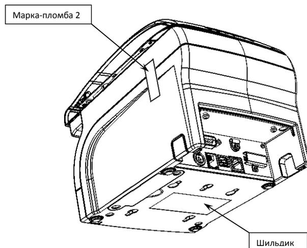
Один элемент марки-пломбы наклеивается на кожух, закрывающий блок управления и устройства печати кассовых чеков так, чтобы было невозможно получить доступ к внутренней части ККТ без разрушения марки-пломбы. Шильдик наклеивается на дно корпуса ККТ.
