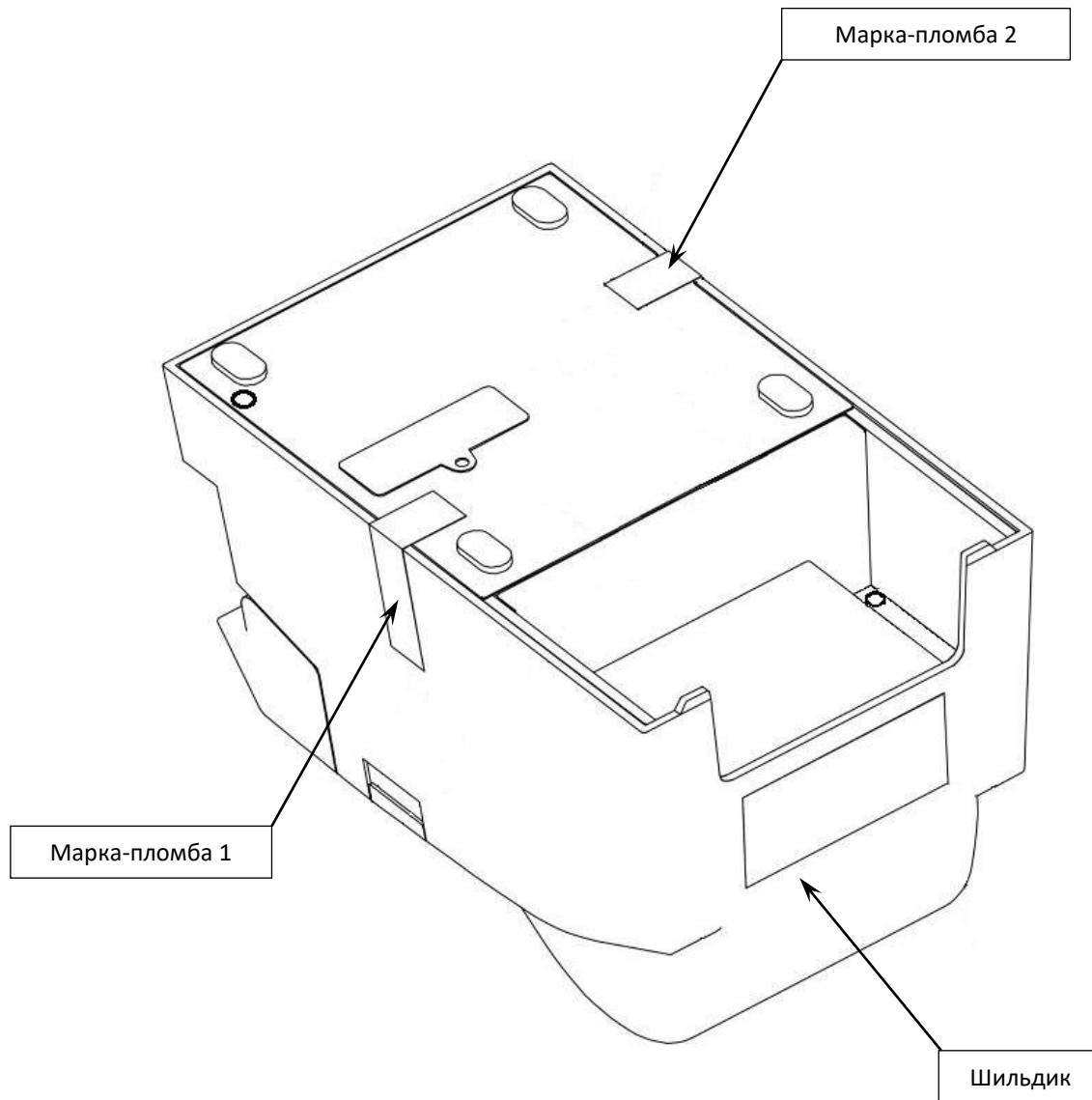
Два элемента марки-пломбы наклеиваются на кожух, закрывающий блок управления и устройства печати кассовых чеков так, чтобы было невозможно получить доступ к внутренней части ККТ без разрушения марки-пломбы. Шильдик наклеивается на дно корпуса ККТ.
