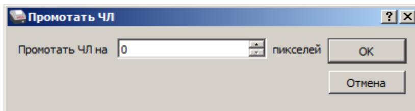
В строке **Промотать ЧЛ на** задать размер отступа перед печатаемой строкой в пикселях.
