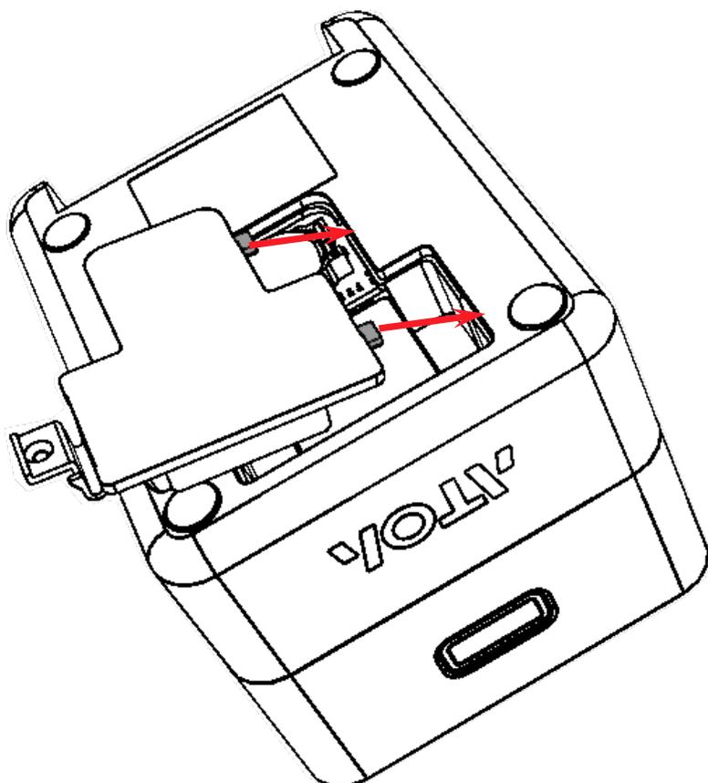
**10** Сначала установить крышку отсека ФН, контролируя положение фиксаторов.
