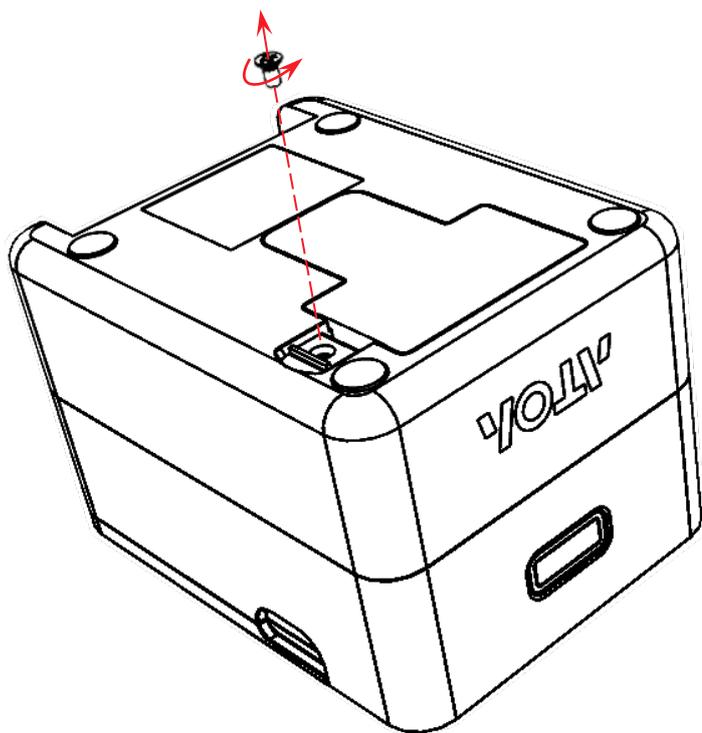
Рисунок 6. Винт крепления крышки отсека для ФН
