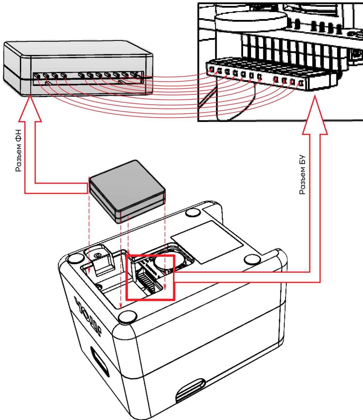
Рисунок 9. Установка и подключение ФН в отсек
