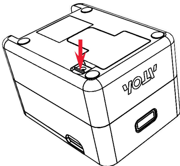
**11** Надавить на фиксатор крышки до щелчка.
